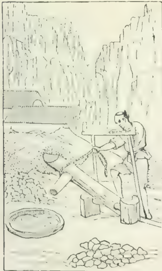
Abbildung 20. Stampfen des Feldspats für die Porzellanfabrikation in China.
